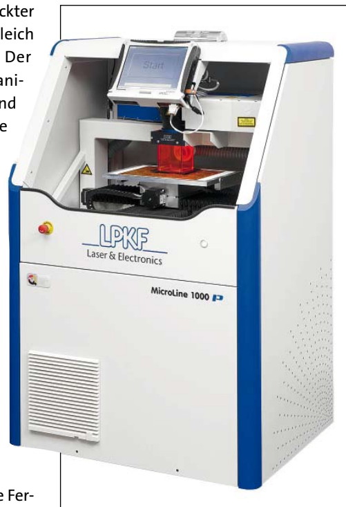
Bild 1: Besonders wirtschaftlich und flexibel: Das UV-Laser-Schneidsystem LPKF Microline 1000P (alle Bilder: LPKF)
