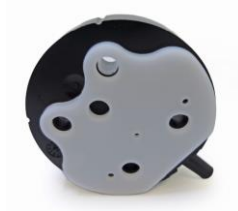
Bild 2: Eines der Schlüsselbauteile des Geräts: Der Ventilblock bestehend aus einem lasertransparenten und einem laserabsorbierenden Kunststoffelement - fest verschweißt und getestet für Drücke bis 400 bar
